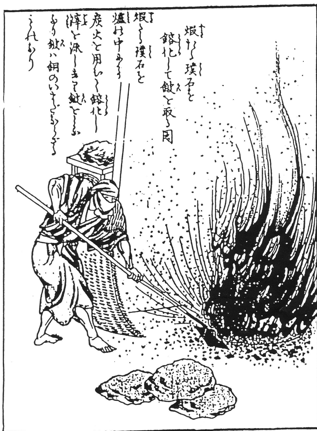
鉱石熔錬作業（鼓銅図録）
